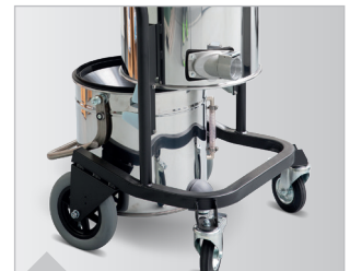
Bequemes Ausleeren des Behälters ohne Abnehmen des Saugerkopfes dank ablösbarem Behälter.
