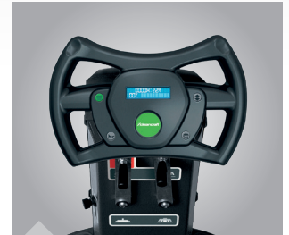
Ergonomischer Lenker mit Bedienelementen und Display
