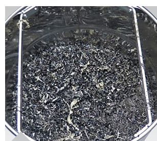
Edelstahlbehälter ist unempfindlich gegenüber scharfkantigen Metallspänen
