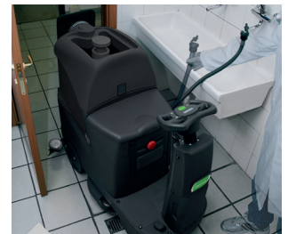
Frischwassertank mit Schlauch für Schnellbefüllung
