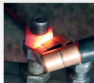
› Erwärmen einer Mutter mit der Fokusspule schräg
