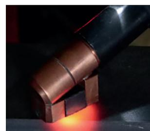
› Erwärmen eines Bauteils mit der Fokusspule schräg
