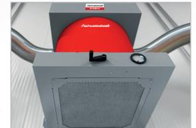
Integrierte Hebevorrichtung für den Filterwechsel
